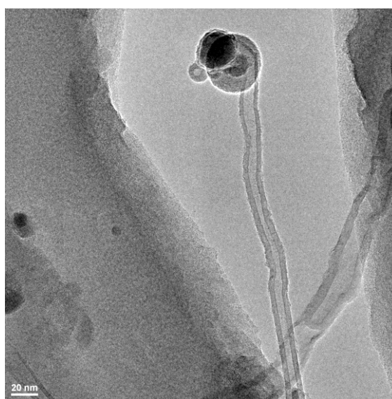
Fig. 5. Imagini TEM ale nanotuburilor obținute din nanopulberi de fier învelite în carbon
